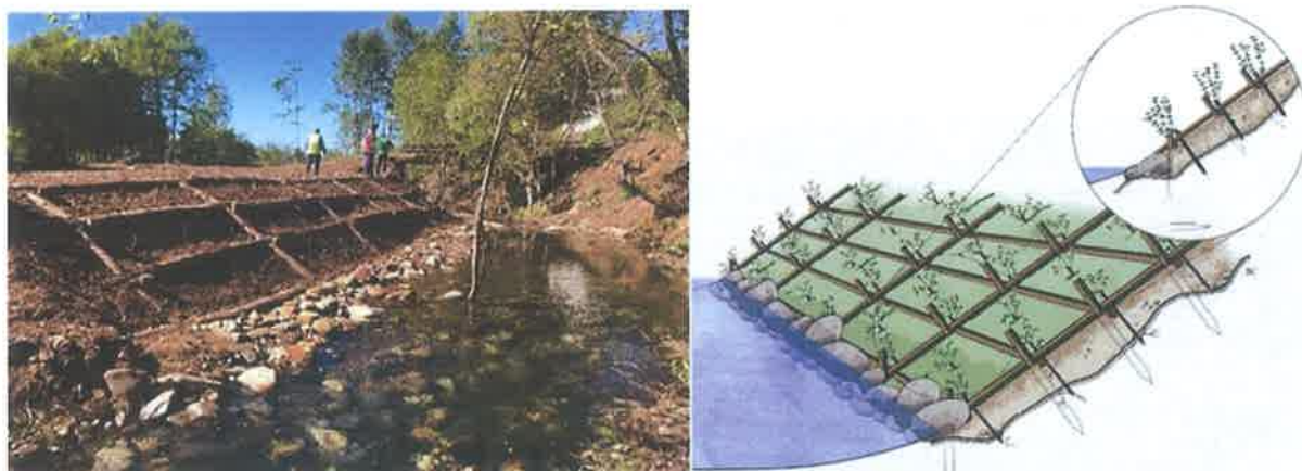
Figura 17 – Grade viva (fotografia, seção transversal e alçado)
