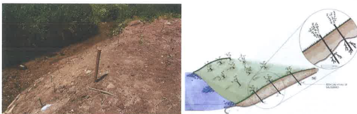
Figura 25 - Estacaria viva (fotografia, secção transversal e alçado)
