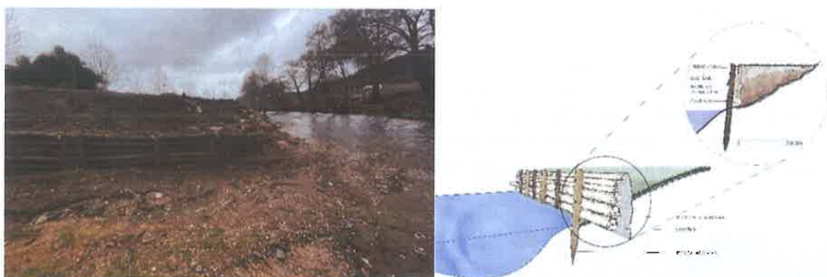
Figura 14 – Paliçada viva (fotografia, secção transversal e alçado)
