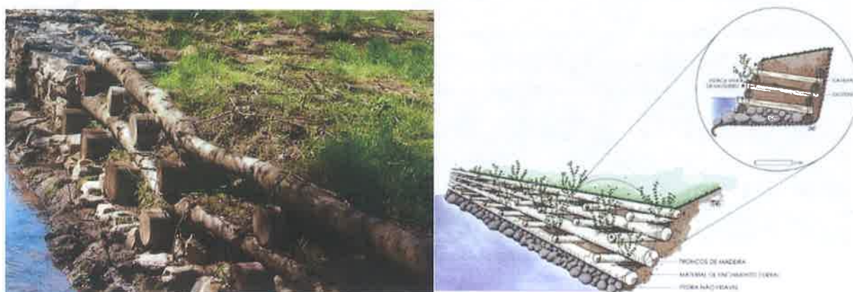
Figura 18 – Muro vivo (fotografia, secção transversal e alçado)
